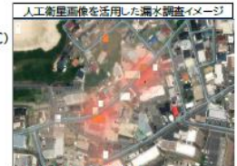
人工衛星画像を活用した漏水調査イメージ ※漏水リスクエリアを赤色で表示
